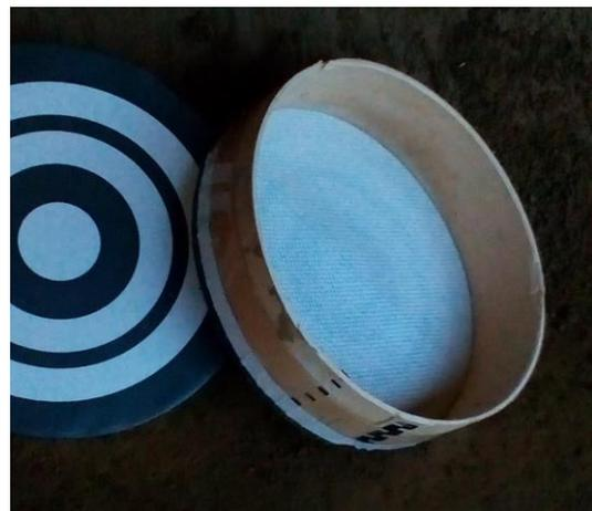
切断・面取り後：枠幅 12cm→9.5cm
